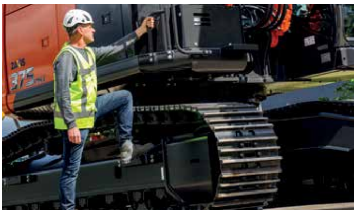
La main courante facilite l'accès à la tourelle pour les opérations de maintenance.
