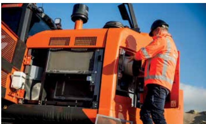
Cette configuration efficace permet un accès facile à tous les filtres.
