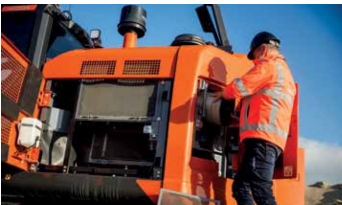
Die durchdachte Oberwagenkonstruktion ermöglicht einen einfachen Zugang zu allen Filtern.
