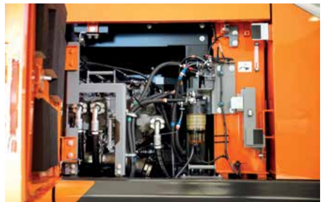
Das TRIAS-Hydrauliksystem reduziert den Kraftstoffverbrauch.
