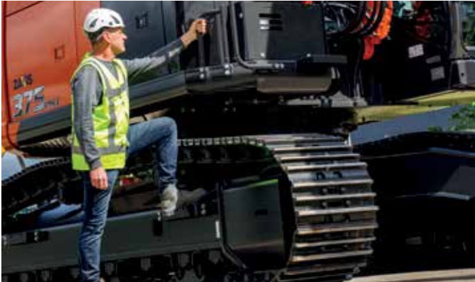
Der Handlauf ermöglicht einen einfachen Zugang zum Oberwagen für Wartungsarbeiten.
