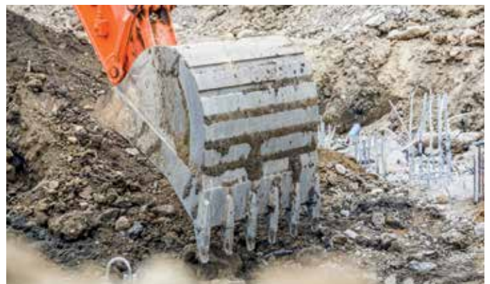
Hitachi Bodeneingriffsteile verfügen über selbstschärfende Zähne und zuverlässige Adapter für einen passgenauen Anschluss.
