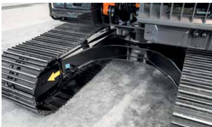
Les progrès effectués au châssis inférieur ont amélioré la durabilité.
