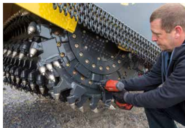
Remplacement des segments latéraux sans démonter le rotor.
