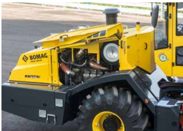
Accès facile aux points d'entretien : filtre à eau, AdBlue, installation de lubrification centralisée.
