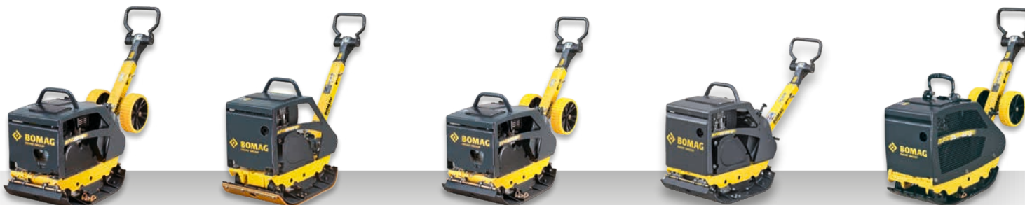
BPR 25/40 Poids en charge: 135 kg Force centrifuge: 25 kN Largeur utile: 400 mm
