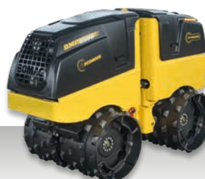
BMP 8500 Poids en charge: 1.595 kg Force centrifuge: 72/36 kN Largeur utile: 610 mm / 850 mm
