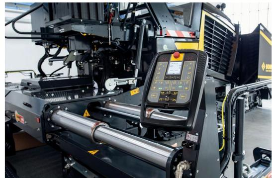
Tout contrôler depuis le côté. Le contrôleur de nivellement intégré et l'inclinaison automatique garantit une qualité irréprochable.
