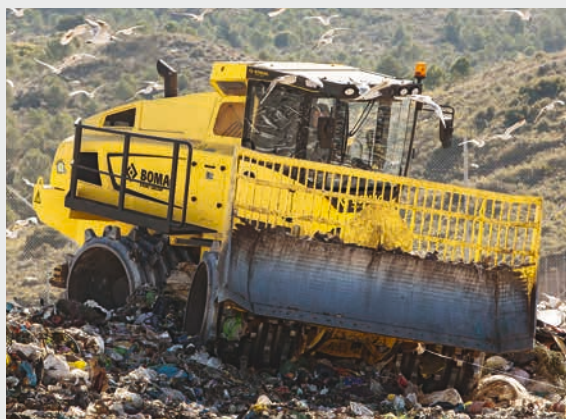
Compactage idéal grâce au joint oscillant assurant aux roues de compactage une bonne répartition de la charge.
