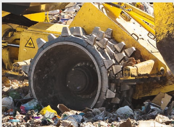
Les grattoirs garantissent la propreté des roues et le bon niveau de compactage.
