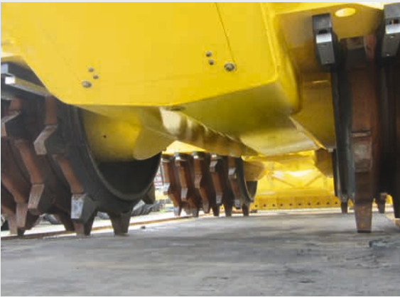
Châssis fermé pour une protection idéale de tous les composants qui empêchent l'intrusion de matériaux ; aucun risque d'embrasement sur les composants très chauds.
