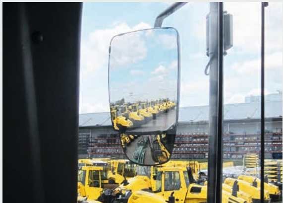
Grands rétroviseurs de chaque côté et grandes zones vitrées pour une excellente visibilité du pourtour.
