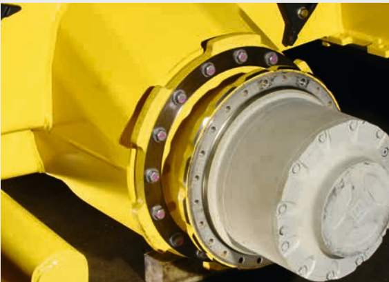
Deux systèmes indépendants de freinage (hydrostatique pour le frein de service et à disques multiples pour le frein de parking).
