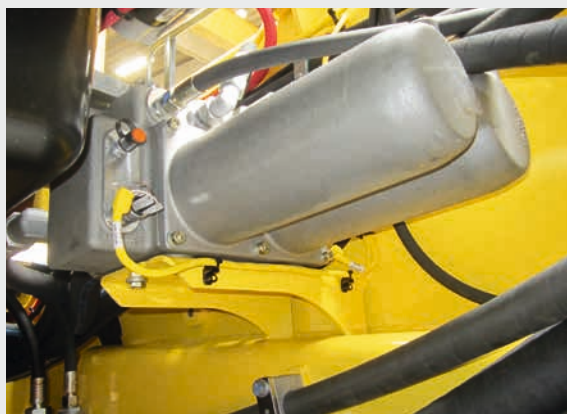
Surveillance électronique du système de filtre hydraulique de retour.
