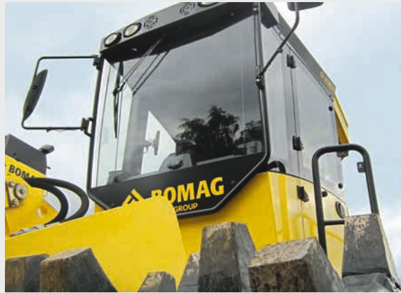
La conception de la cabine est conforme ROPS et FOPS.
