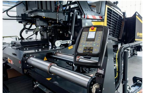
Tout contrôler depuis le côté. Le contrôleur de nivellement intégré et l'inclinaison automatique garantit une qualité irréprochable.
