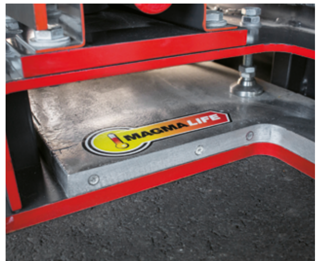
Fast 60 % schnellere Erhitzung – mit der einzigartigen MAGMALIFE-Bohlenheizung.
