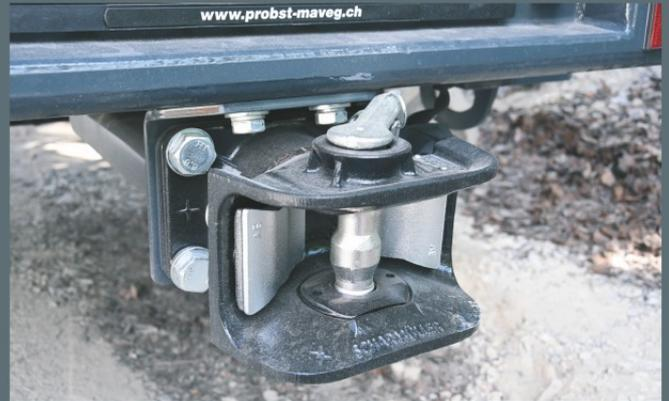
Standardausrüstung: Schrammüller Anhängerkupplung mit 7-poliger Steckdose
