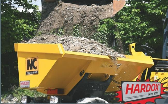
Heavy Duty HARDOX Mulde aus hochfestem Stahl für herausragende Stabilität und Langlebigkeit
