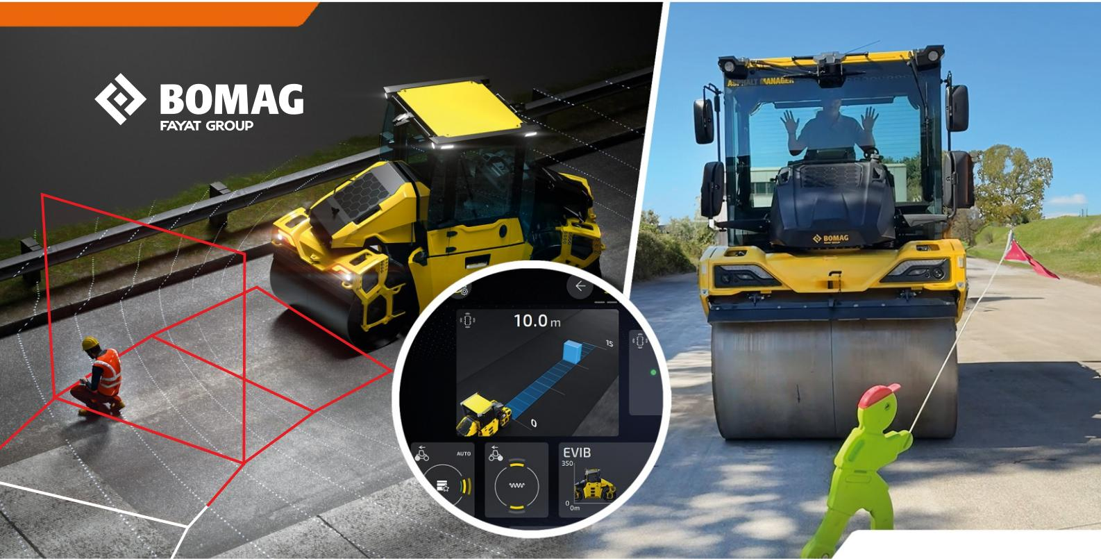
**L'ange gardien du chantier routier : prévention des accidents et des collisions grâce au freinage automatique de la machine, basé sur la technologie LiDAR de dernière génération.**
